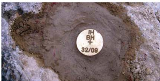
Fig. 8 - Marca de nivelamento "IH BH 32/09"
