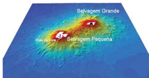
Fig. 17 - Modelo digital de terreno com base nos dados preliminares do levantamento hidrográfico das Ilhas Selvagens.
