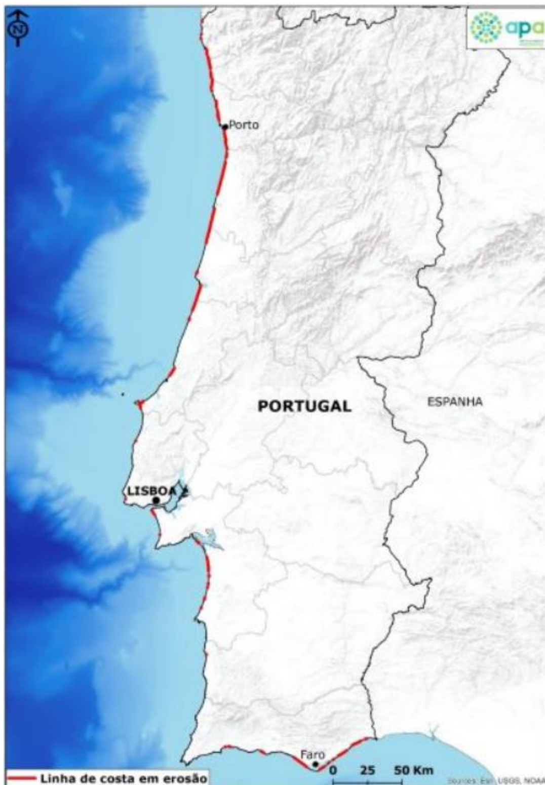
Figura 3 – Troços de linha de costa em situação de erosão (período 1958-2021)
