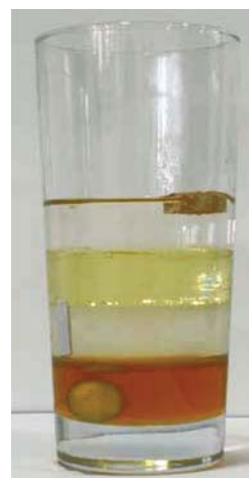
Figura 2 - Distribuição das camadas formadas pelas substâncias líquidas (mel, água, óleo de cozinha e álcool etílico) e sólidas (rodela de rolha de cortiça, um pedaço de plástico, berlinde) com diferentes densidades.
