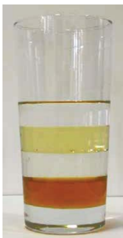
Figura 1 - Distribuição das camadas formadas pelas substâncias líquidas (mel, água, óleo de cozinha e álcool etílico) com diferentes densidades.
